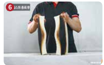
6 테스트 후 단면 확인 - 탄화막 형성으로 내부 연소 불가
